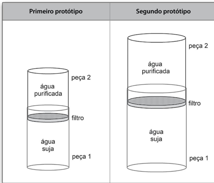
No primeiro protótipo, ao aplicar uma força  $F$  sobre a peça 2, cria-se, na água suja, uma pressão  $p$ .
