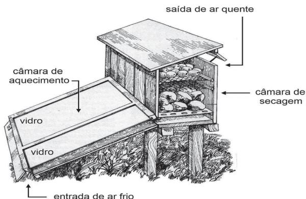
Imagem seccionada de uma estufa, mostrando o interior da câmara de aquecimento e o interior da câmara de secagem onde são colocados os alimentos.
